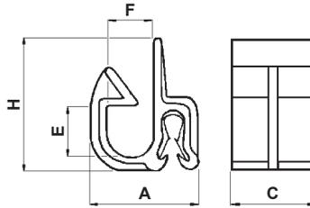
QUESTI PRODOTTI SONO IDONEI AD ESSERE MONTATI SUL BORDO DI SUPPORTI DI VARIO TIPO, PER MEZZO DI UNA MOLLETTA DI ACCIAIO MUNITA DI DENTINI DI RITENZIONE. TALE CONFORMAZIONE PERMETTE DI EVITARE FORATURE, PUR ASSICURANDO UNA BUONA TENUTA DI FISSAGGIO. IL CORPO IN PLASTICA GARANTISCE UN OTTIMO ISOLAMENTO ELETTRICO.
